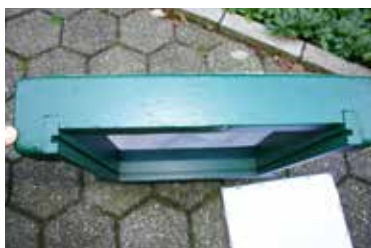
Boden von hinten, Schubladennut sichtbar
